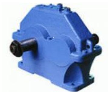
Цилиндрический редуктор является самым популярным типом редукторов, которые используются в машиностроении. Данный агрегат применяется в механизмах с повторно-кратковременным режимом нагрузок. Одноступенчатый цилиндрический горизонтальный редуктор используется для снижения вращательной частоты с целью увеличения крутящего момента.
