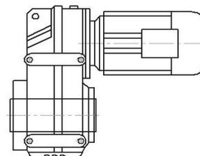
Полый выходной вал со шпоночным пазом.
